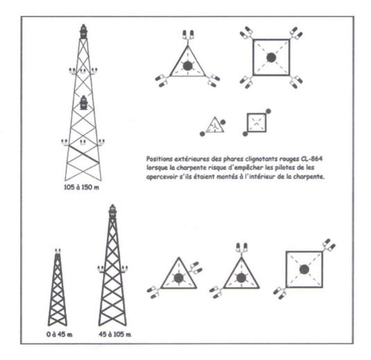
Article 53.- Si des feux rouges permanents L-810 sont installés à un niveau intermédiaire sur une tour haute de 105 m AGL ou moins, au moins deux feux rouges permanents sont disposés à des endroits diagonalement ou diamétralement opposés. Au moins l'un des feux doit être bien visible à partir de tout angle d'approche, sinon on installe autant de feux nécessaires au respect de cette obligation.
