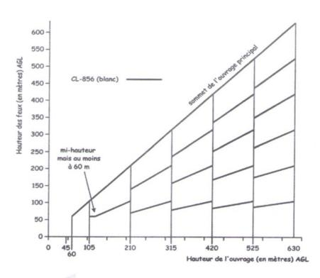
Article 74.- On installe au moins trois feux à chaque niveau intermédiaire et on les monte de façon à s'assurer qu'aucun élément de la structure ne nuit à l'intensité efficace de la couverture horizontale totale du faisceau.
