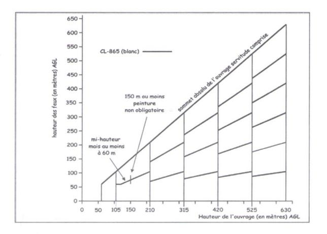
Article 60.- Au niveau supérieur, on installe un ou plusieurs feux au point le plus élevé d'une tour afin d'offrir une couverture de 360 degrés garantissant une vue bien dégagée.
